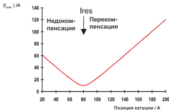
Рис. 2.11: Величина тока утечки в зависимости от настройки катушки Петерсена (V кривая)
